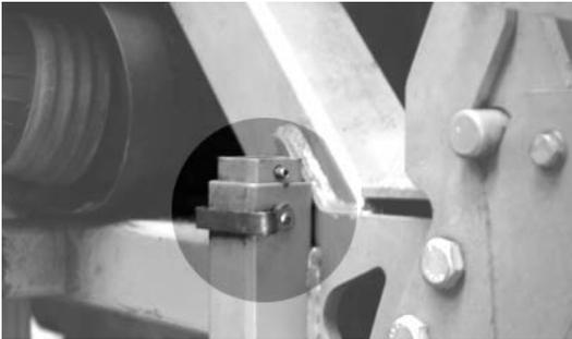
2. Placer les guidages arrière à droite et à gauche en position et fixer avec la goupille de retenue.
