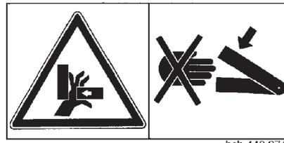
Ne pas s'approcher de la zone de danger d'écrasement, tant que des pièces y sont encore en mouvement.
