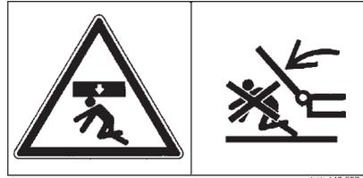
Ne pas stationner dans l'aire d'évolution de l'appareil.
