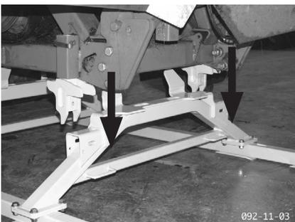
4. La protéger du basculement en la calant avec les guidages avant sur la béquille.
