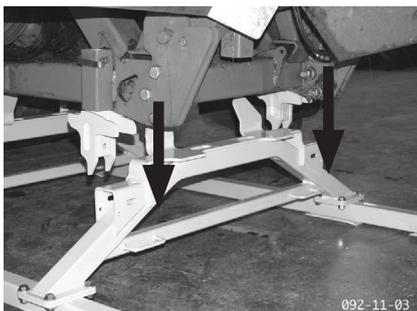
4. Con le guide anteriori dei supporti d'appoggio fermare la struttura evitandone il ribaltamento mediante l'incastro.
