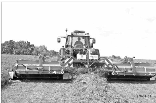
Con il nastro trasportatore trasversale sono possibili diversi tipi di deposizione (andana singola, andana larga o triplice). Con il comando il nastro trasportatore trasversale può essere aperto o chiuso ed è possibile regolare in continuo la velocità del nastro per unità.
