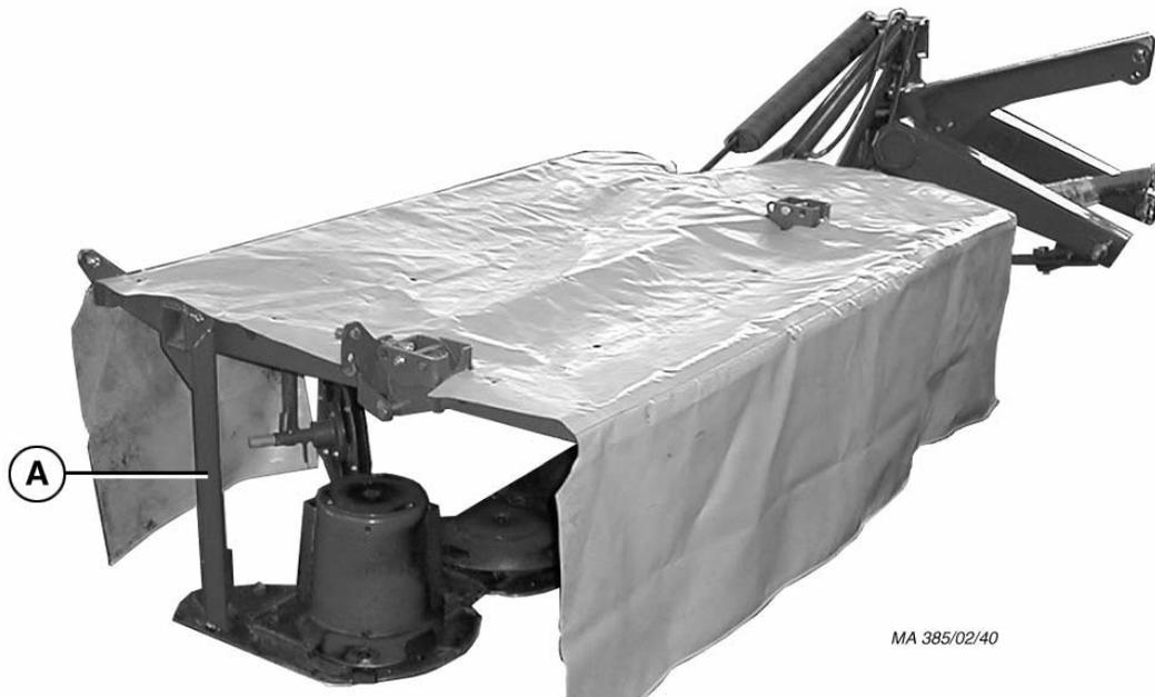
Wenn unter schwierigen Einsatzbedingungen (z.B. sehr langes Gras, niedrige Fahrgeschwindigkeit, Mähen am Hang) die Strebe A zu Störungen führt (Anhäufung von Erntegut), so kann sie bei den Typen Nova Disc 225 und 265 entfernt werden. Bei den Typen 305, 350 und 400 ist dies **nicht** zulässig!
