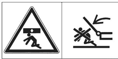
Ne pas rester sous la charge ni dans la zone de pivotement des pièces en mouvement.
