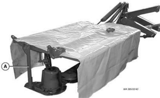
Lors de conditions de travail difficiles (p. ex. herbe très longue, faible vitesse de déplacement, fauchage en pente) la barre "A" peut provoquer des accumulations de fourrage, elle peut être démontée sur les Novadisc 225 et 265. Sur toutes les autres Novadisc; 305;350 et 400, le démontage **n'est pas possible**
