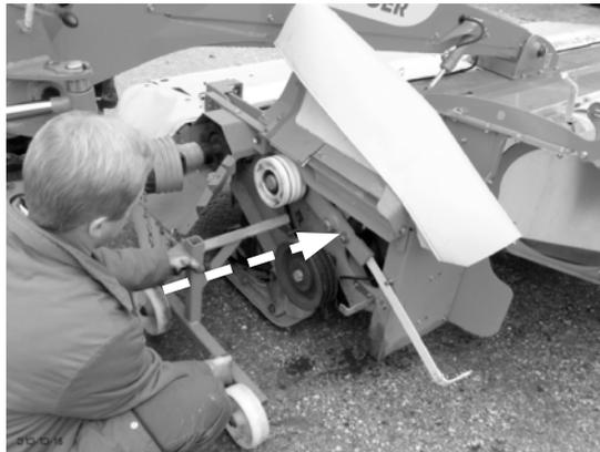
11. Spannhebel (4) entfernen
