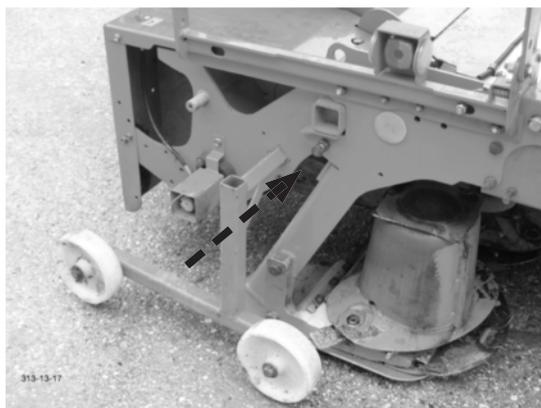
14. Befestigungen links und rechts lösen
