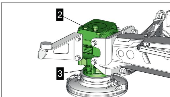
2 = bouchon de remplissage avec jauge
