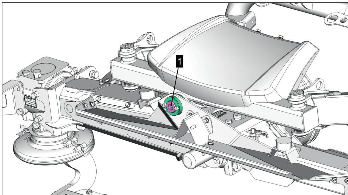
1 = graisseur de la barre de coupe et du palier oscillant
