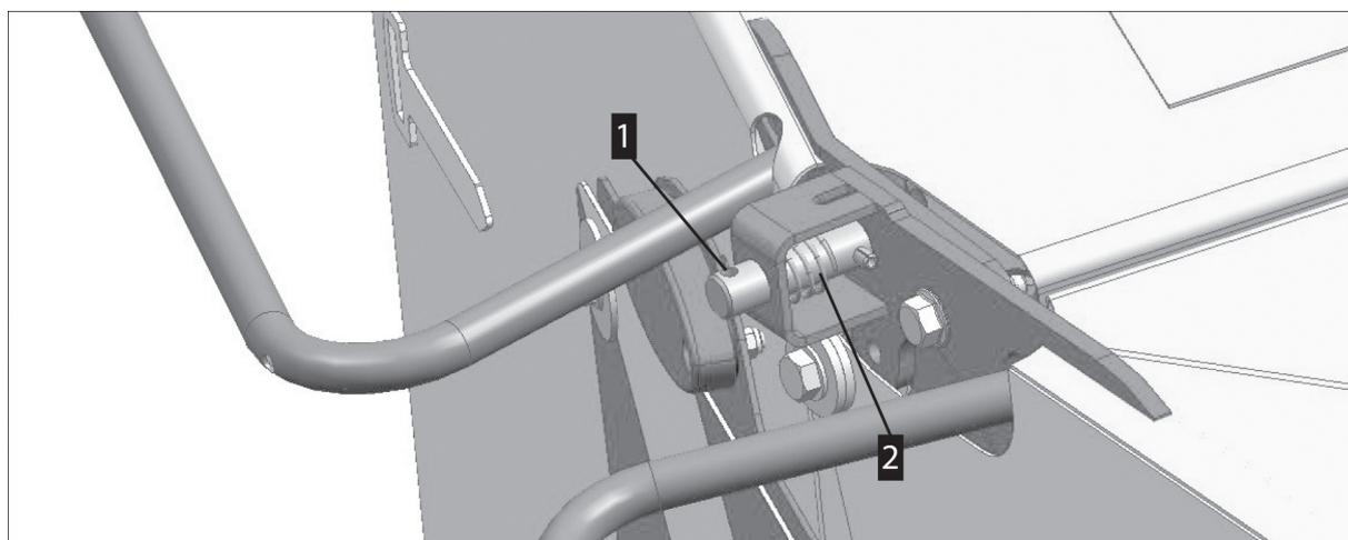
1 = axe de verrouillage avec un trou
