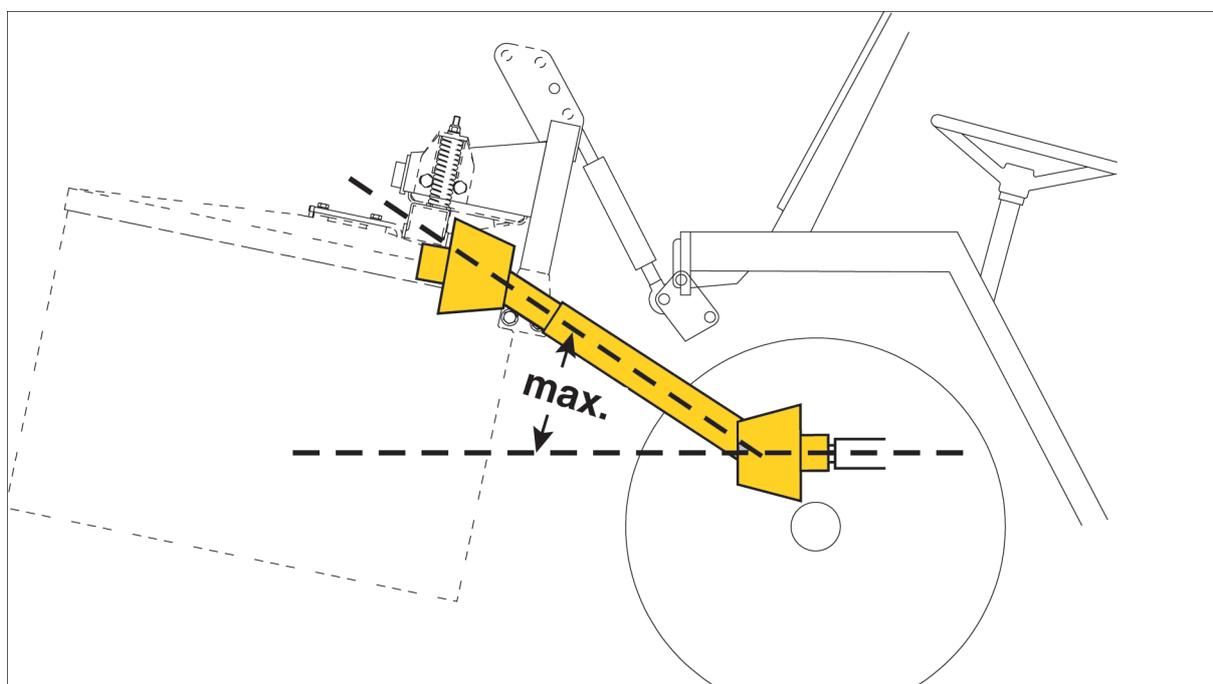
max = angle maximal autorisé pour les cardans de transmission
