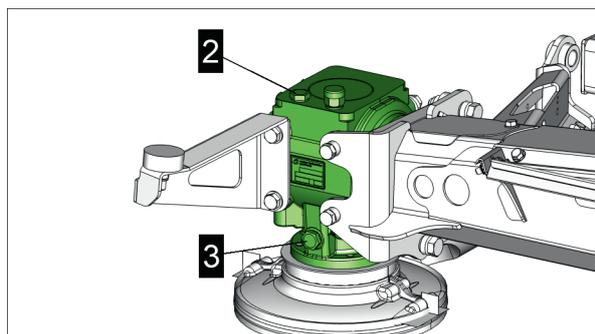
2 = Bouchon de contrôle avec jauge de niveau d'huile
