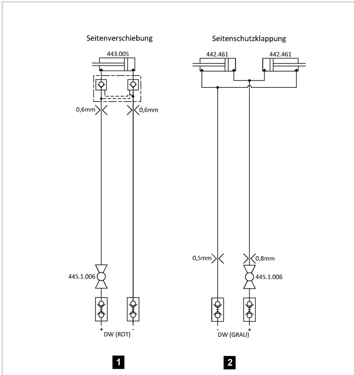
1. Raccord hydraulique à double effet pour l'option de déplacement latéral hydraulique (rouge)
