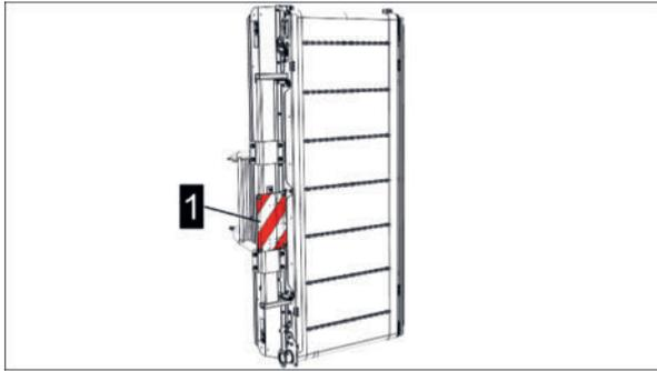
1 = Warntafel an beiden Seiten der Maschine
