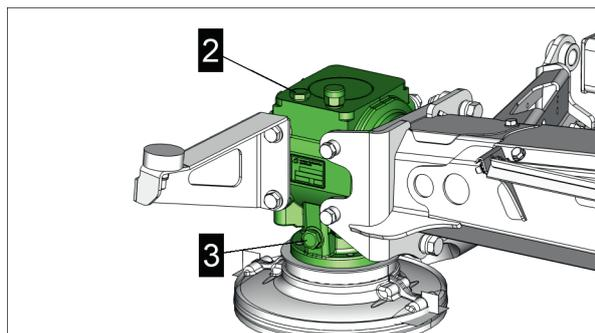
2 = vite di controllo del livello di riempimento dell'olio con asta di misurazione dell'olio
