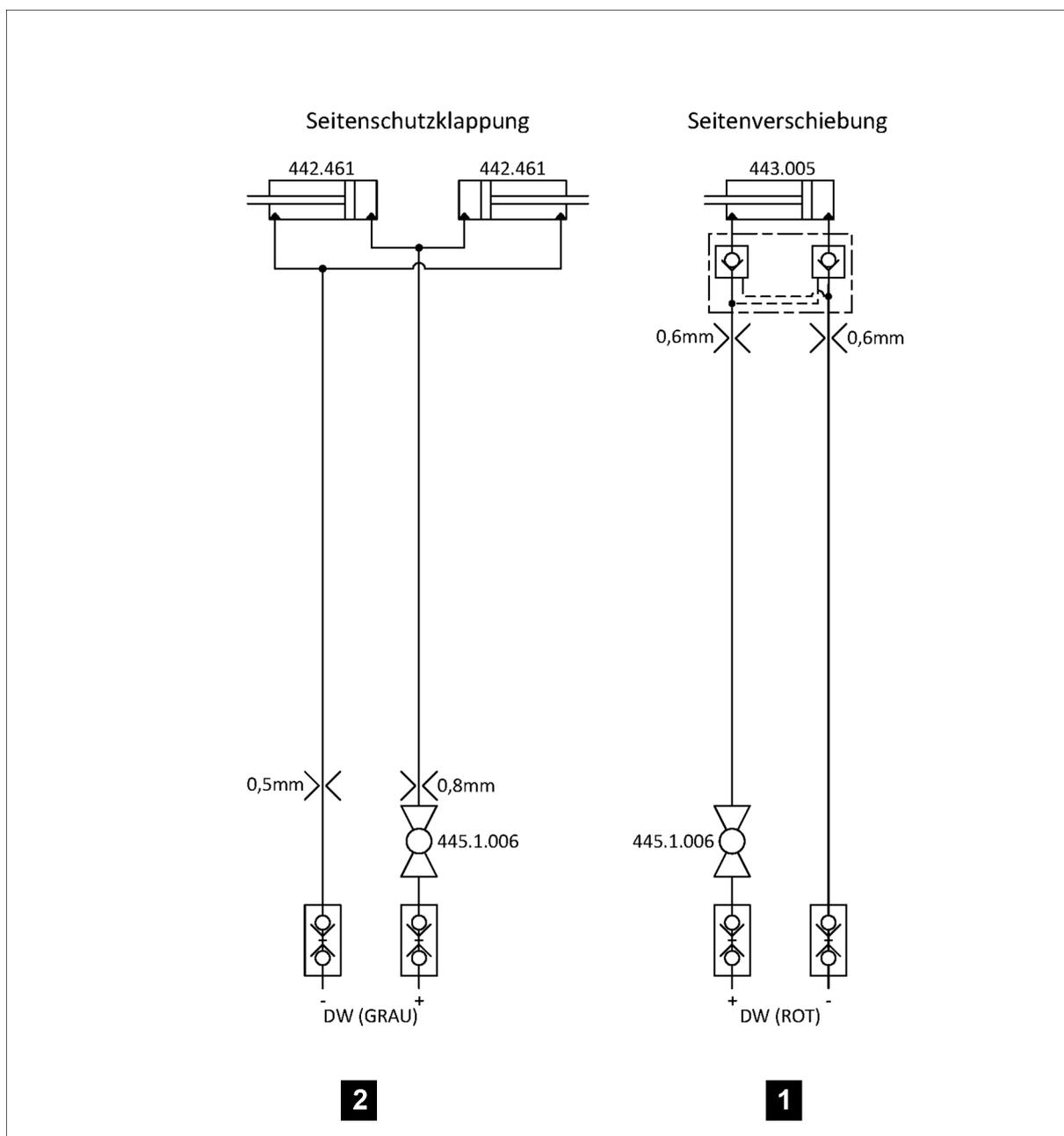
1. Collegamento idraulico a doppio effetto per opzione spostamento laterale idraulico (rosso)
