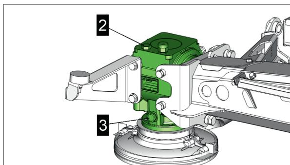
2 = vite di controllo del livello di riempimento dell'olio con asta di misurazione dell'olio
