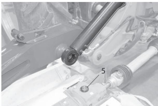
Unterer Bolzen: Schraube und Scheibe entfernt.
