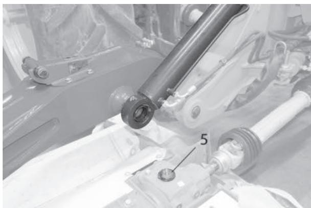
Axe inférieur : Vis et rondelle retirées.
