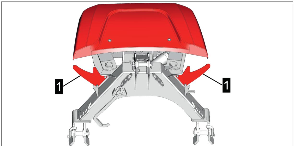
Abb.: Seitenverschiebung in Mittelstellung
