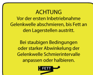
Fig.: Autocollant sur le cardan
