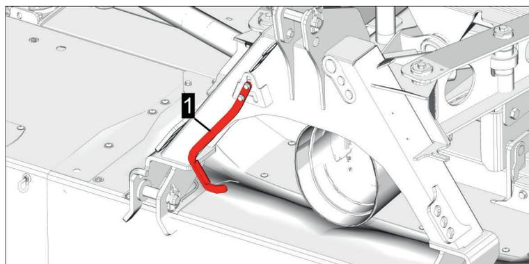
Fig.: Supporto albero cardanico in posizione di lavoro
