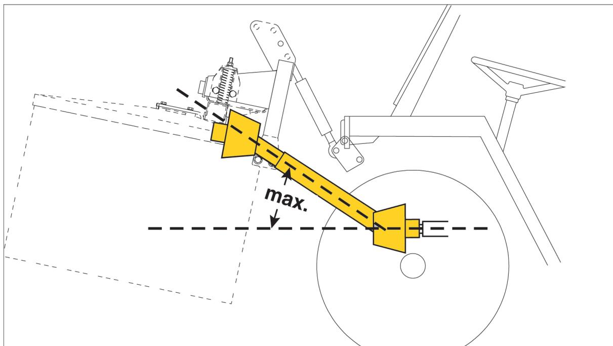
Fig.: max. = esempio della deflessione massima consentita di un albero cardanico
