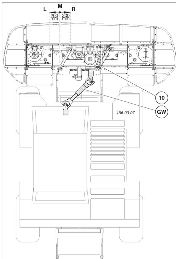
Fig.: Esempio di spostamento laterale della macchina fino al massimo a destra.
