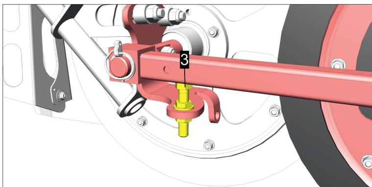
▷ Stringere nuovamente i dadi (1) e (2) senza ruotare ulteriormente la vite (3).
