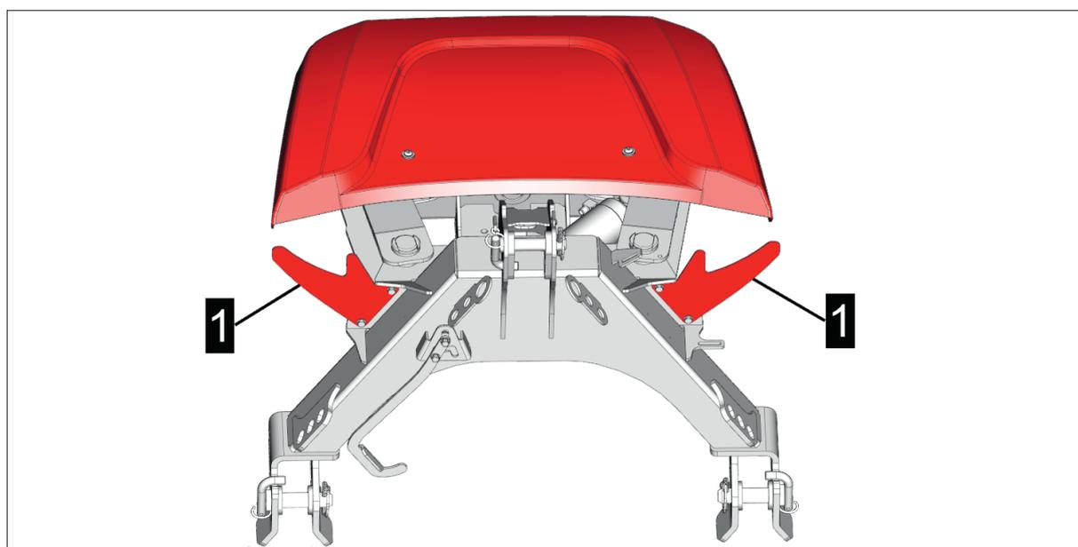
Fig.: Spostamento laterale in posizione centrale
