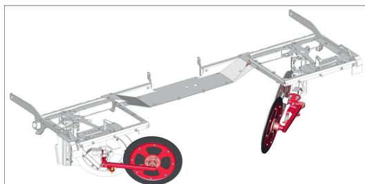
Fig.: Il pannello di protezione non si vede nella figura. Andanatore supplementare (optional)
