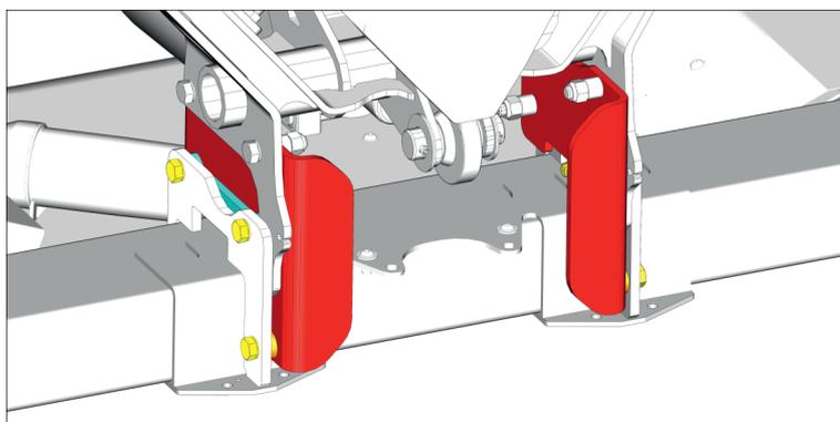
Fig.: Protezione anteriore mostrata in trasparenza.
