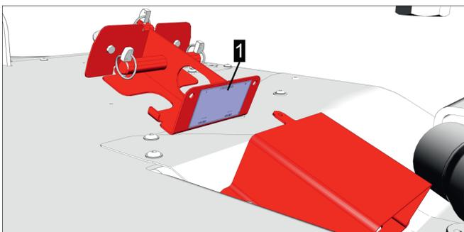
L'attrezzatura della lama utilizzata è indicata sull'adesivo attaccato al box delle lame.
