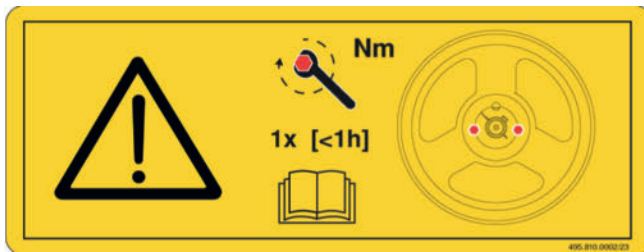
Fig.: Le pictogramme d'avertissement sur le protecteur de courroie trapézoïdale correspondant indique qu'un entretien unique est nécessaire.
