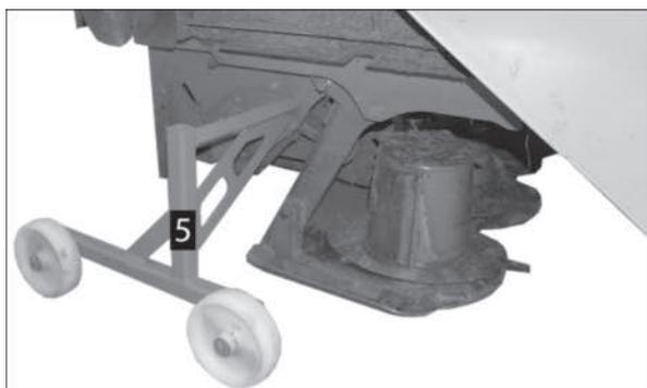
7 Rimuovere il bullone di fissaggio e conservarlo per un ulteriore utilizzo con la protezione posteriore o se il condizionatore deve essere rimontato successivamente.
