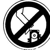
Das Besteigen ist bei laufender Maschine verboten
