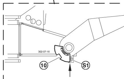
Contrôle de l'usure des fixations de couteaux
