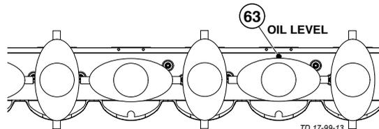
L'huile est trop visqueuse lorsqu'elle est froide. Trop d'huile usagée reste sur les roues dentées. Par conséquent, le résultat de mesure serait erroné.
