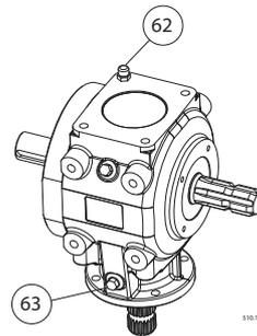
**Engrenage cylindrique pour conditionneur (SG)**
