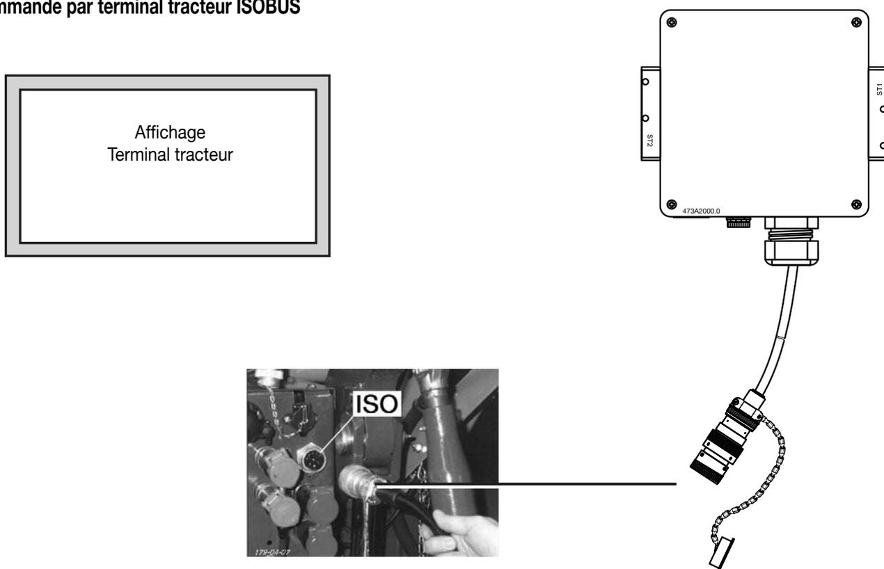
Schéma de commande - Faucheuse avec Isobus
