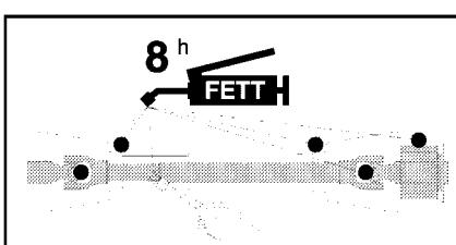
En cas d'utilisation en hiver graisser les tubes protecteurs pour éviter qu'ils ne se bloquent ensemble par le gel.
