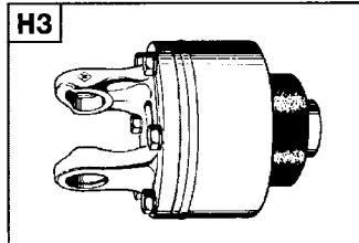
Die Einschaltdrehzahl der Kupplung liegt unter 200 U/min.
