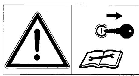
Vor Wartungs- und Reparaturarbeiten Motor abstellen und Schlüssel abziehen.
