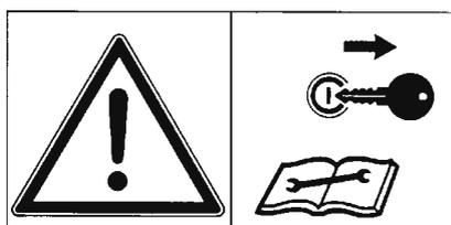
Arrêter le moteur, retirer la clef et consulter la notice d'utilisation avant toute opération de maintenance ou de réparation.
