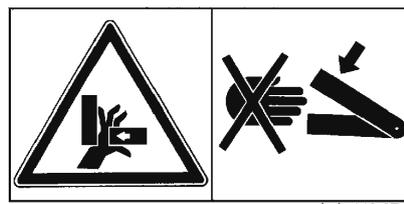
Risque d'écrasement des doigts ou des mains tant que les pièces sont en mouvement.
