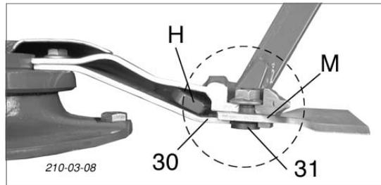
7. Contrôle visuel du bon positionnement du couteau (M) entre le boulon (31) et la lame de ressort (30) (voir schéma).
