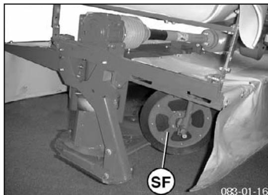
Montage du conditionneur (CR) ou des disques d'andainage (SF):
