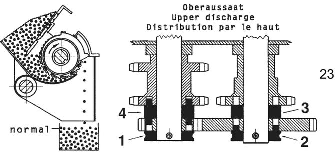
**Halving sowing shaft r.p.m.**
