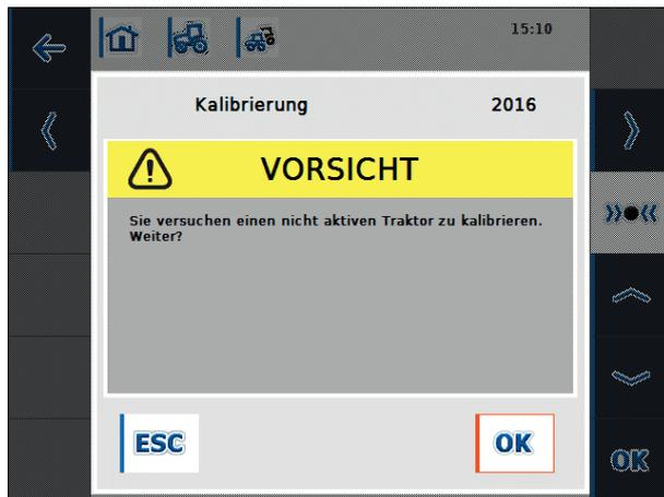
Figure 8-17: Requêtes de sécurité pour le calibrage
