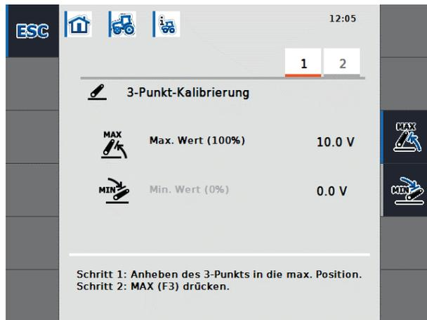
Figure 8-23: Étalonnage de l'attelage 3 points - Valeur maximale
