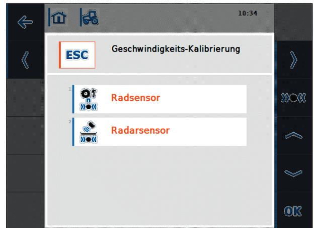
Figure 8-18: Étalonnage de la vitesse
