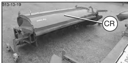
Le montage du conditionneur (CR), des disques d'andainage (SF) ou de la "bâche arrière"
