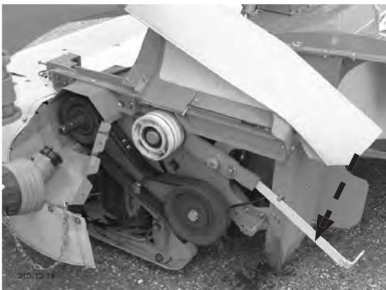
8. Déposer les courroies
