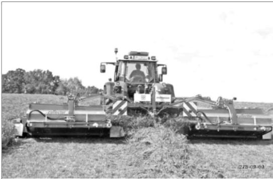
Les tapis de dépose latérale permettent une dépose de l'andain sur d'une largeur variable (dépose simple; assemblée; triplée). Les tapis sont relevés ou abaissés et la vitesse de ceux-ci sont réglés individuellement en continu par le terminal.
