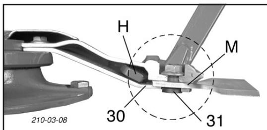
7. 7. **Contrôle visuel !** Contrôler la bon positionnement (39) du couteau (M) entre le téton (31) et la lame de ressort (30) (voir schéma) (40).
