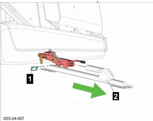
2. Mettre la goupille de sécurité (1) dans la béquille de dépose
