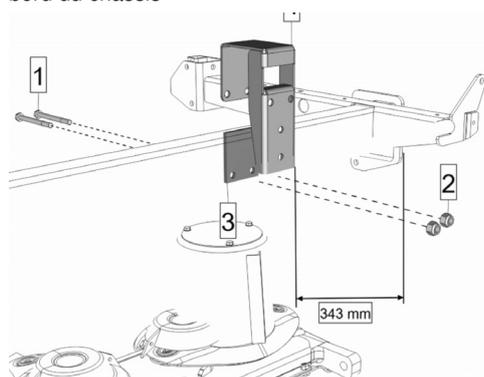
Sur la gauche, cela signifie aucune distance du bord du châssis.
