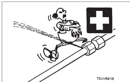
Avant de brancher les flexibles hydrauliques, vérifier la compatibilité avec le système hydraulique du tracteur.
