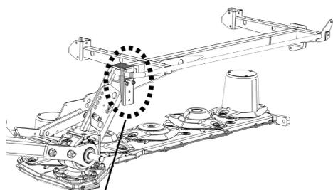
2. Monter les disques d'andainage aux consoles. Montez les disques d'andainage de manière à ce qu'ils soient 10 mm sous le bord inférieur de la barre de coupe (ils ne doivent pas toujours le sol au travail).
