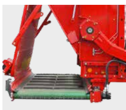
Příčný zakládací dopravník
