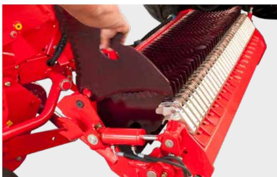
Premendo il tasto di attivazione dello sbloccaggio centralizzato dei coltelli, questi vengono sbloccati e possono essere estratti senza bisogno di utensili.
