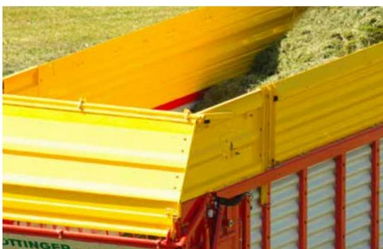
La sovrastruttura in profilato d'acciaio è completamente chiusa. Le pareti laterali con un rivestimento particolare garantiscono una lunga durata di vita. Il carro non necessita di archi di sovrastruttura, in quanto la struttura è sporgente rispetto allo sportello per la compressione del foraggio. L'ampio sportello per la compressione del foraggio garantisce una compressione ottimale del foraggio ed un riempimento totale del vano di carico.
