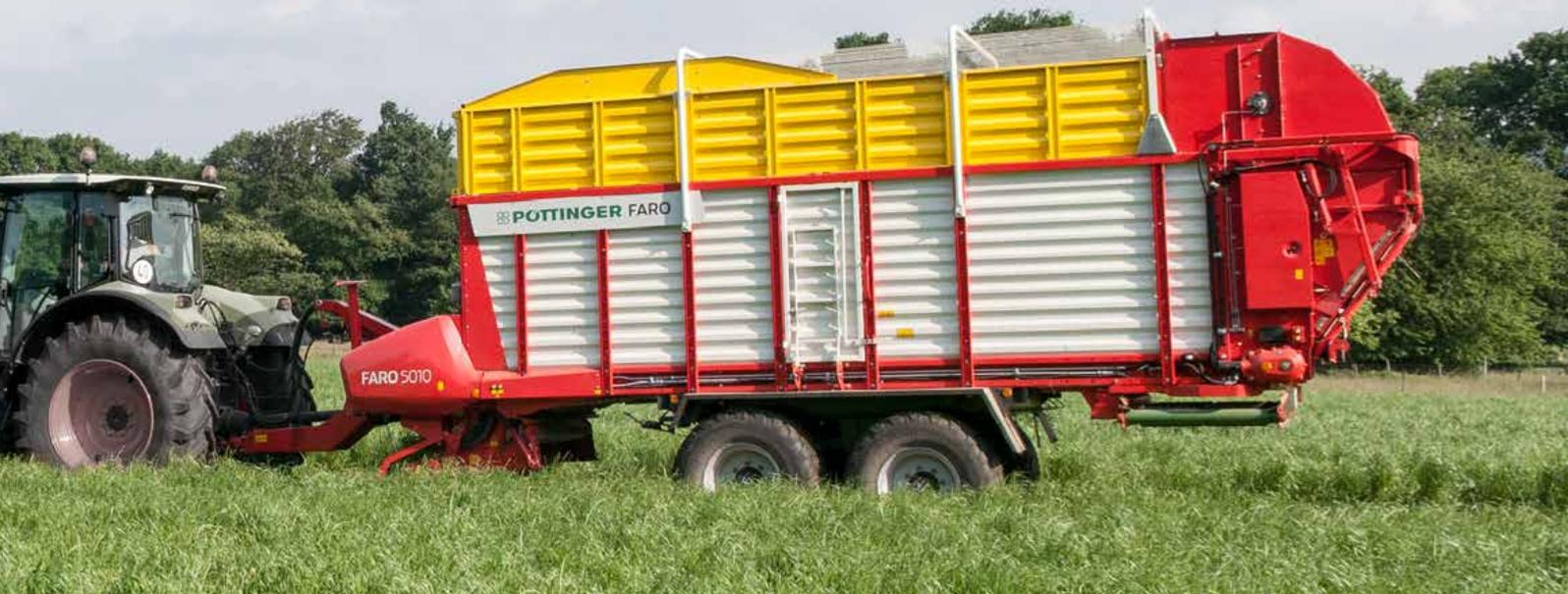
Il dispositivo automatico di carico garantisce un riempimento totale, con conseguente capacità di trasporto elevata. Il foraggio viene compresso delicatamente già nel canale di convogliamento, sfruttando appieno il vano di carico.
