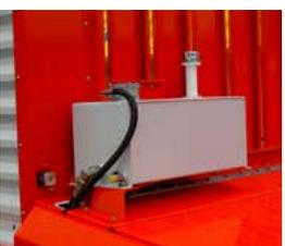
**Impianto idraulico per nastro trasportatore trasversale**
