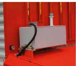
**Hidráulica a bordo para la cinta transportadora transversal**
