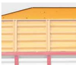
**Chapa adicional estructura superior para estructura completa en acero**
