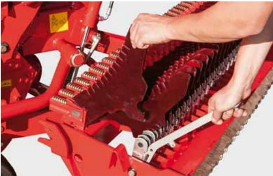
31 cuchillas para un corte corto de 45 mm.
