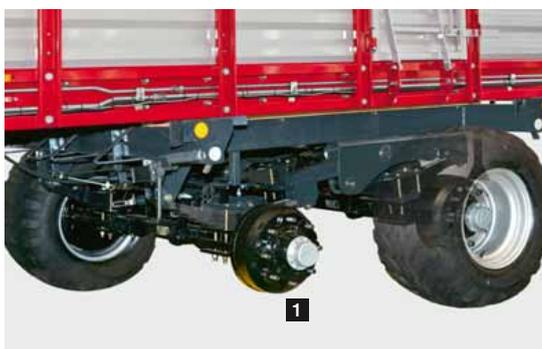
**Chasis Tandem con ballestas, 10,5 t carga por eje, 17" (1).** De serie en FARO 3510 / 4010.
