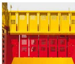
**Chapa de carga automática con plegado hidráulico**
