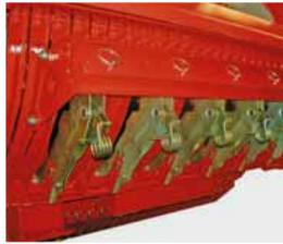
**Bastidor para enroscar 6 / 11 cuchillas**
