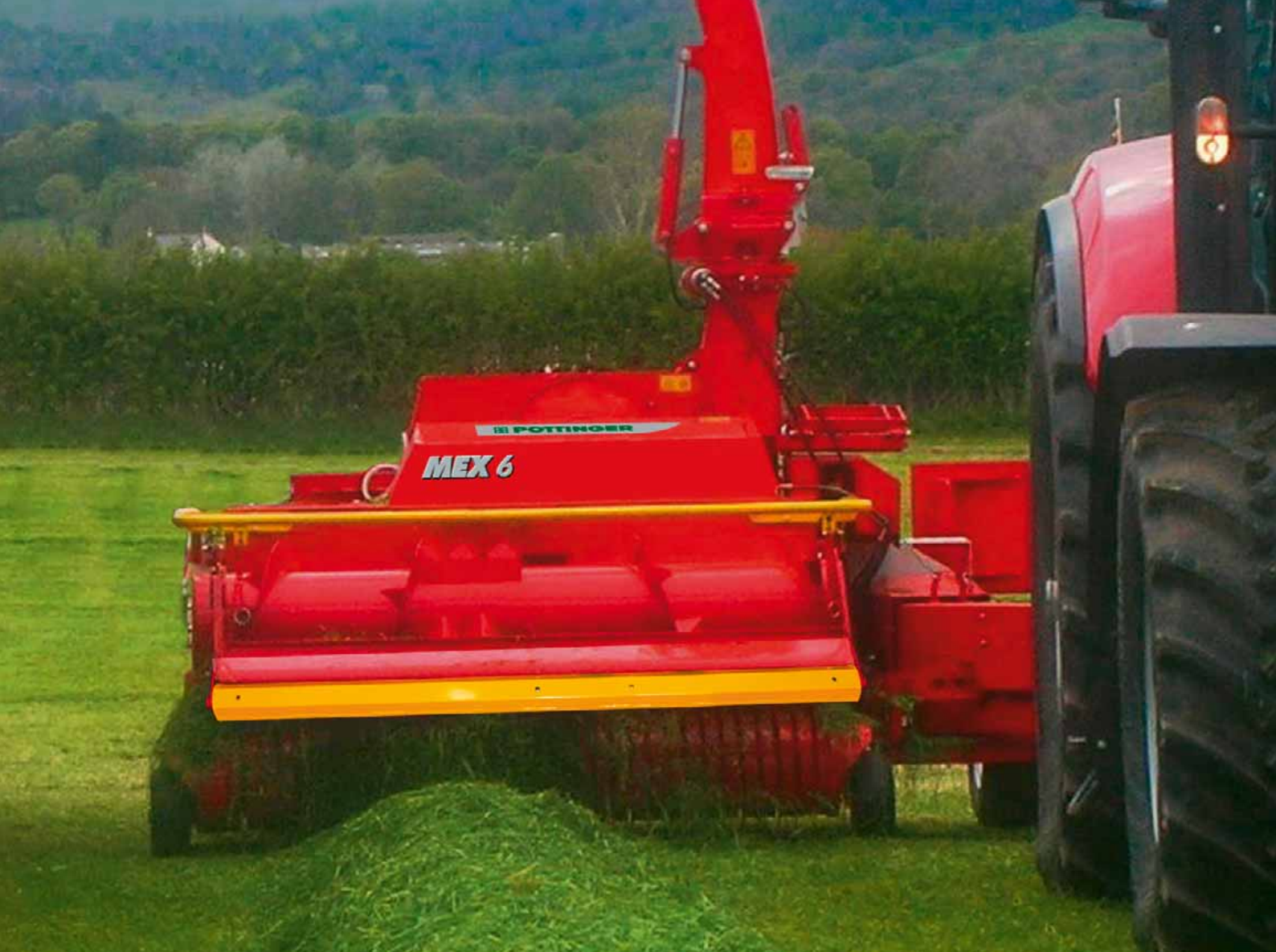
MEX 6 – Trincia erba trainata con pick-up da 1,90 m
