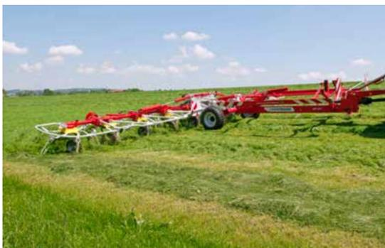
Прицепные ворошилки НІТ Т с восемью, десятью и двенадцатью роторами были специально разработаны для работы на больших площадях. Чтобы объединить в себе большую рабочую ширину и прекрасную адаптацию к поверхности поля, роторы по отдельности соединены друг с другом через вал. Благодаря шасси, выступающему в качестве направляющего ротора, ворошилки НІТ Т гарантируют высококачественную работу даже при большой рабочей скорости.
