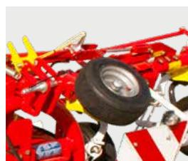
Система ворошения на краю поля гидравлическая
