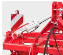
Regolazione idraulica della profondità di lavoro
