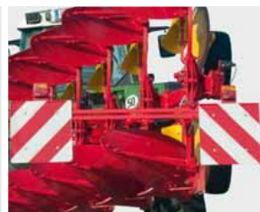
Panneaux de signalisation et éclairage
