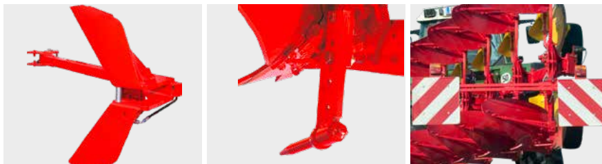
Гидравл. откидное крепление для уплотн. катка
