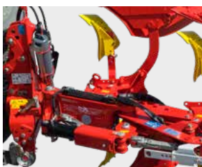
Válec pro výkyv pluhu při otáčení na úvratích
