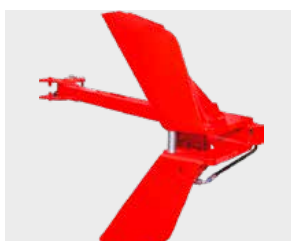
Hydraulické rameno pro uchycení válce
