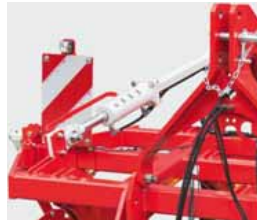
Réglage hydraulique de la profondeur de travail
