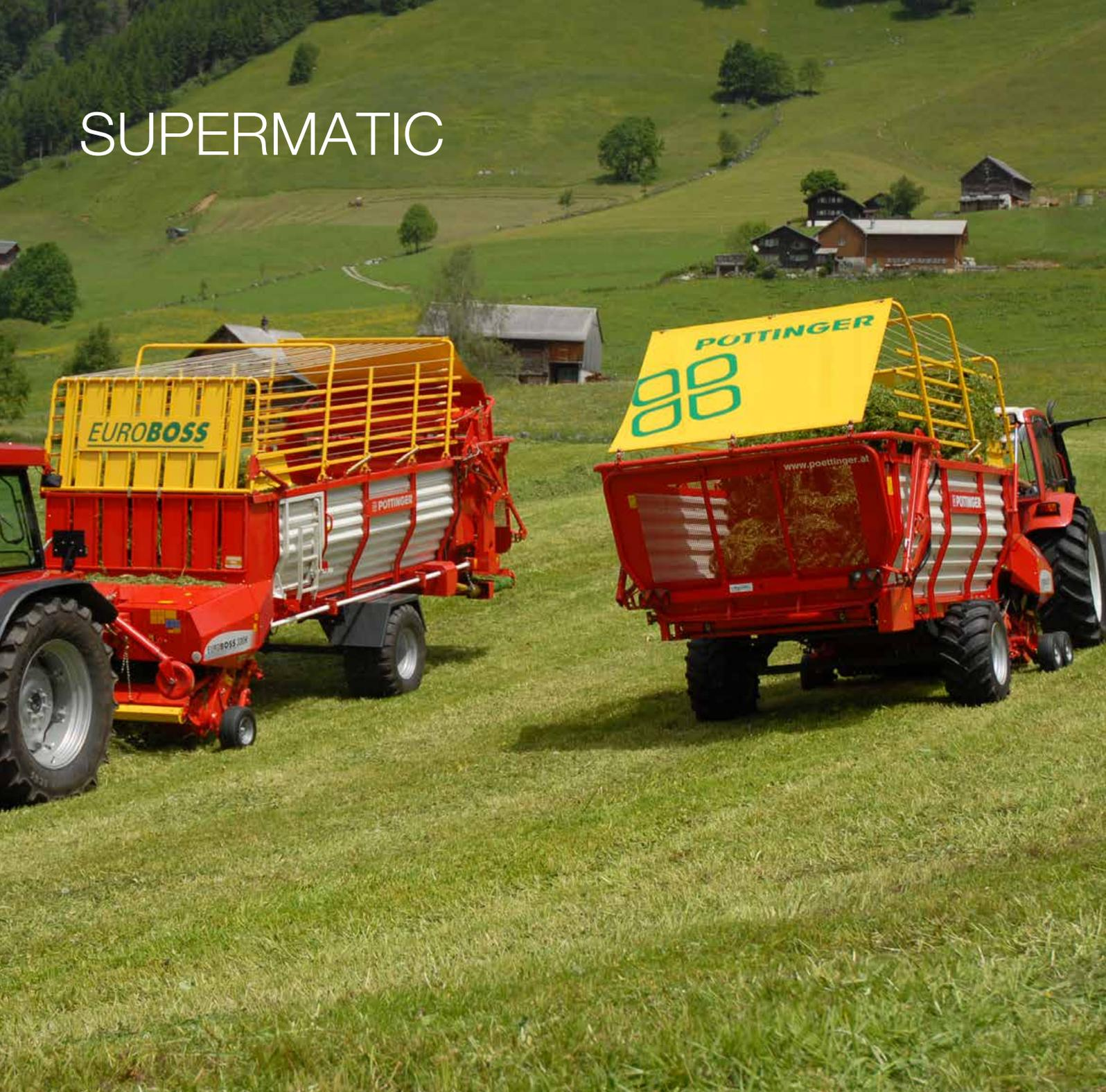
Il grande spazio di convogliamento e la sequenza rapida delle pinne di alimentazione proteggono il foraggio e garantiscono la massima prestazione di carico. Un dispositivo di carico particolarmente adatto per foraggio verde e fieno.
