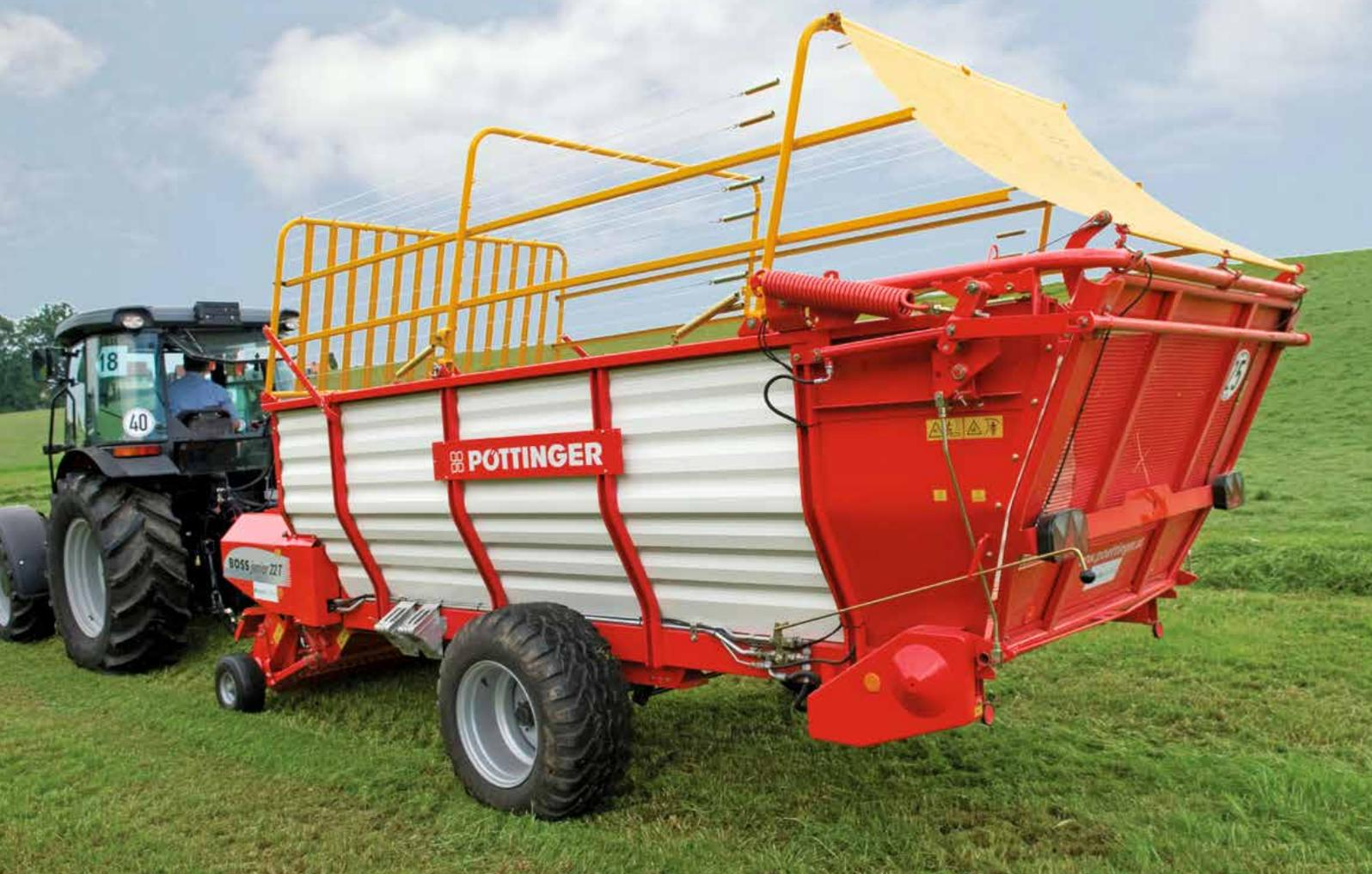
Il dispositivo di carico dei modelli BOSS JUNIOR è costituito da 3 pinne di alimentazione divise con azionamento bilaterale a camme per una ottima prestazione di carico.
