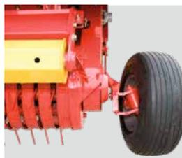
**Ruote tastatori guidate per pick-up**
