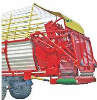
Una distribuzione uniforme del foraggio è il presupposto indispensabile per una compressione perfetta dello stesso. Il dispositivo di dosaggio, costituito da tre rulli dosatori, protegge la macchina, facilitando il lavoro dell'operatore. Su richiesta sono disponibili due rulli dosatori per l'impiego nel silo.
