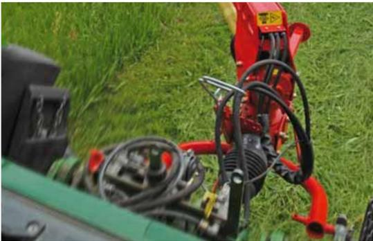
La béquille repliable et les supports de dépose du cardan, des flexibles et des câbles électriques facilitent l'attelage et le dételage. La disposition des câbles électriques et des flexibles hydrauliques dans le timon les protège efficacement et améliore le design.
