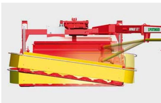
**La fixation totalement mobile du groupe faucheur sur le châssis porteur garantit une adaptation au sol en 3 dimensions.**
