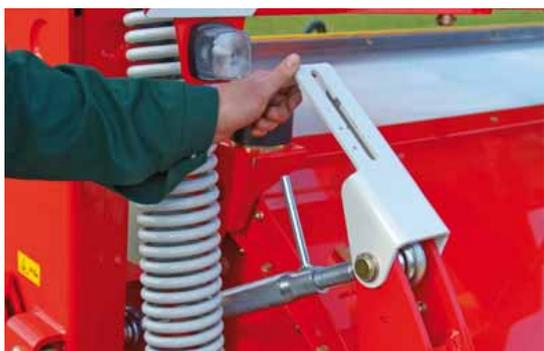
La hauteur de coupe se règle facilement et rapidement au niveau du tirant supérieur. Un dispositif de verrouillage assure le maintien de la position définie. Un indicateur de hauteur de coupe est intégré au verrou.
