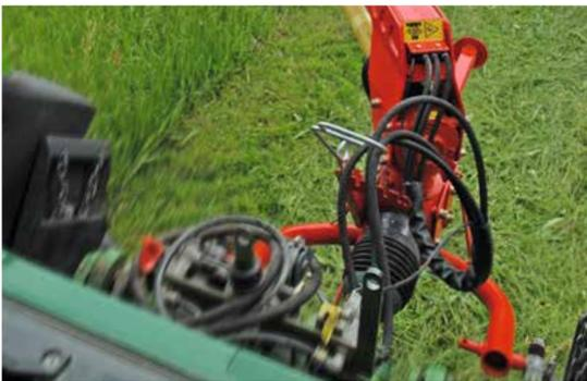
Ein klappbarer Stützfuß und die Gelenkwellen-, Schlauch- und Kabelablage erleichtern das An- und Abkuppeln. Schlauch- und Kabelverlegung in der Deichsel schützt vor Beschädigung und verbessert die Optik.
