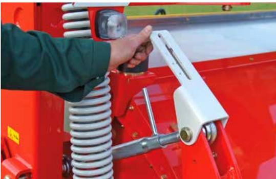
Die Schnitthöhe lässt sich über den Oberlenker rasch und einfach anpassen. Gegen selbsttätiges Verstellen ist er mit einer Klappe gesichert. Die Schnitthöhenanzeige ist in der Klappe integriert.
