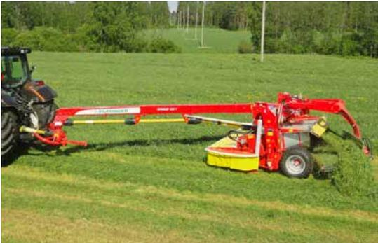
**Um den Ansprüchen hoher Transportgeschwindigkeiten gerecht zu werden, wurden Deichsel und Fahrwerk entsprechend robust ausgelegt. Großdimensionierte Bereifungen leisten dafür ebenso einen wichtigen Beitrag.**
