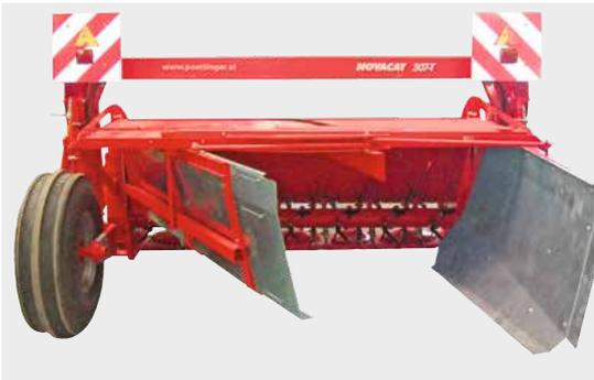
**Eine kostengünstige Form der Schwadzusammenführung wird mit der Schwadversetzung über hydraulisch verstellbare Schwadleitbleche angeboten.**
