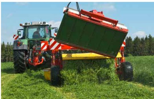
**Beim Mähen ist Flexibilität gefragt. Schlagkraft und variable Schwadablage sind mit dem COLLECTOR-Querförderband garantiert. Drei Ablagemöglichkeiten erfüllen alle Anforderungen.**
