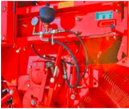
Compensazione idraulica per pick-up
