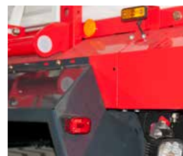
Ліхтарі контурного освітлення та габаритні ліхтарі
