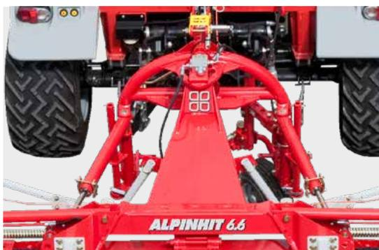
**ALPINHIT 6.6 è un peso leggero a sei giranti. Il nuovo attacco a 3 punti è dotato di serie di un cavalletto sterzante e aste ammortizzatrici.**
