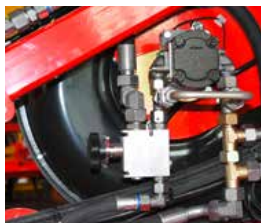
Kuormantunteva puhaltimen käyttö
