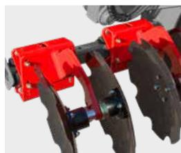
**Дисковый следорыхлитель для трактора**
