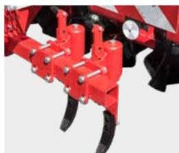
**Подпружиненный следорыхлитель за трактором**
