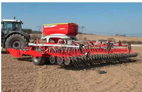
Для транспортировки по дороге несущая пара колес, по желанию, может быть оснащена тормозами. Также для движения на больших скоростях сеялку можно оснастить пневматическими или гидравлическими тормозами для надежного торможения на дороге.
