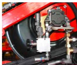
**Azionamento idraulico ventola con Load-Sensing**
