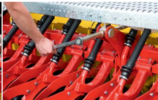
Centrale kouterdrukverstelling – tot 50 kg kouterdruk
