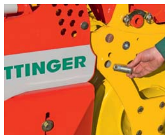
Vergrendelbouten van de steunrol verwijderen – parallelogramgeleiding
