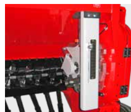
Regolazione elettrica quantità semente
