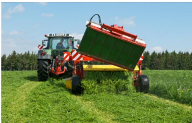
Selbst bei großen Futtermassen arbeitet Ihr Mähwerk durch die große Aufbereiterhaube und das breite Band zuverlässig. Eine saubere Schwadablage bei maximaler Durchsatzleistung ist Ihnen sicher.
