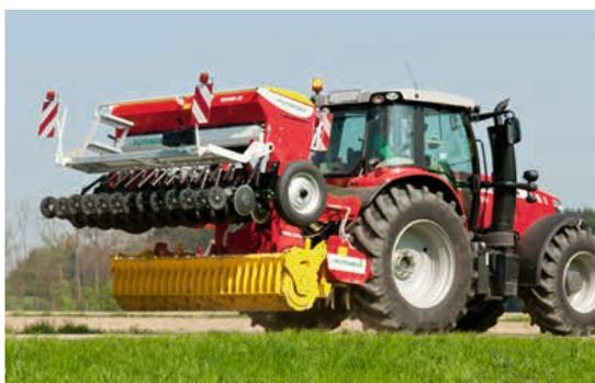
**Навесные сеялки VITASEM можно использовать отдельно или в комбинации с другими агрегатами для обработки почвы.**
