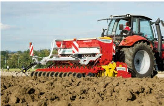
**При работе в поле сеялка постоянно опирается непосредственно на каток. Таким образом, ротационная борона остается абсолютно подвижна и пропускает камни.**
