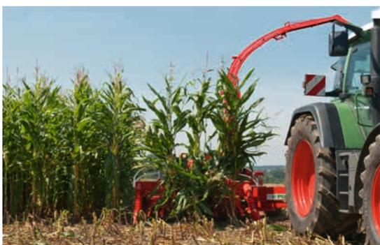
**Благодаря технологии диска с ножами компании PÖTTINGER MEX 6 отличается высокой производительностью и надежностью. Прочная конструкция диска с ножами компенсирует предельные нагрузки, что гарантирует высокую производительность при измельчении травы и кукурузы.**
